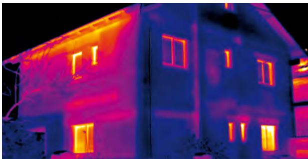
Bauhandwerk: Wärmeverluste von Gebäuden aufspüren.
