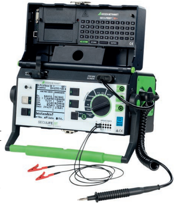
Sicherheitstester Seculife ST mit Anschlussmöglichkeit für zehn Anwendungsteile
