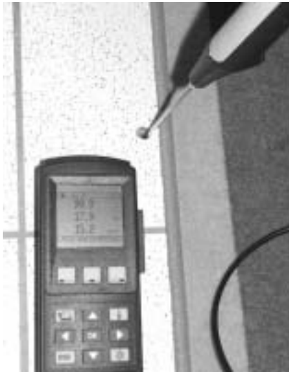
Abb. 20: Messung in Probebohrung eines Fliesenbodens
