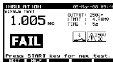
Beispiele von Ergebnissen der Messung des Isolationswiderstands
