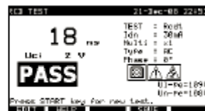
Beispiel für Messergebnisse der RCD-Auslösezeit
