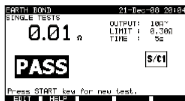
Beispiele von Ergebnissen des Schutzleiterwiderstands Links: Ergebnis für eine bestandene Messung Rechts: Ergebnis für eine nicht bestandene Prüfung
