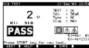
Beispiel für Ergebnisse einer Berührungsspannungsmessung
