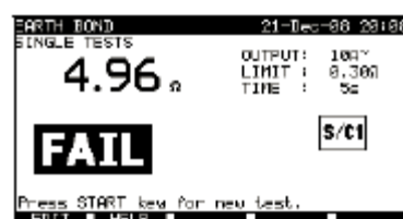
Beispiele von Ergebnissen des Schutzleiterwiderstands Links: Ergebnis für eine bestandene Messung Rechts: Ergebnis für eine nicht bestandene Prüfung
