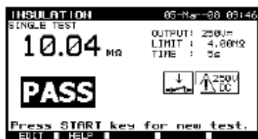
Beispiele von Ergebnissen der Messung des Isolationswiderstands
