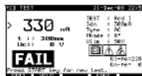
Beispiele für Messergebnisse des RCD-Auslösestroms
