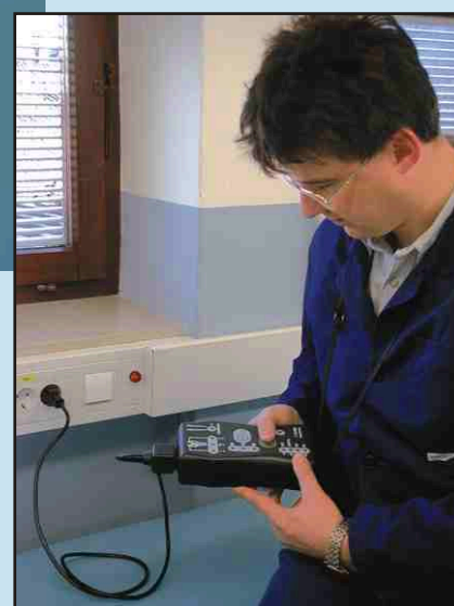
Alle Prüfungen werden direkt an der Steckdose ausgeführt
