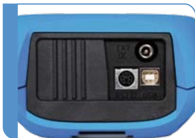
Kommunikation über USB und RS232 Schnittstelle.
