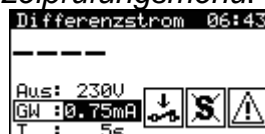
Menü für die Messung des Differenzstroms
