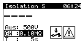
Menü für die Messung des Isolationswiderstands mit Sonde
