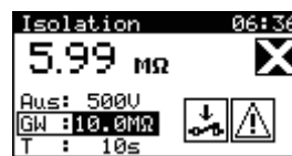
Beispiele von Ergebnis-Displays des Isolationswiderstands
