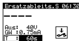
Menü für die Messung des Ersatzableitstroms – Sonde
