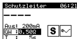
Menü für die Messung des Schutzleiters
