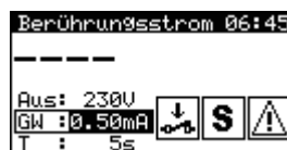
Menü für die Messung des Berührungstroms
