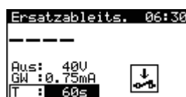
Menü für die Messung des Ersatzableitstroms
