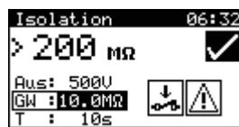
Beispiele von Ergebnis-Displays des Isolationswiderstands
