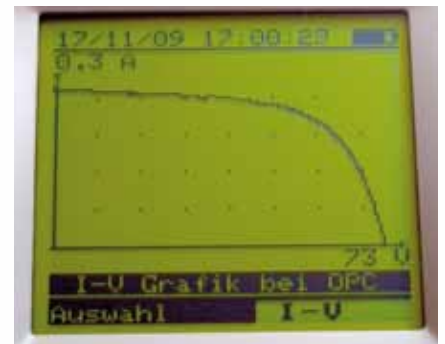
Die Ergebnisse können auch sofort grafisch als I-U Kennlinie dargestellt werden, inkl. automatischer Auswertung OK / Nicht OK
