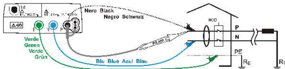
Abb. 21: Geräteanschluss zur einphasigen oder doppelphasigen Messung der 230 V P-PE Schleifen-Impedanzmittels Einzelkabeln und Tastkopf
